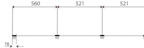
Distanza guide con policarbonato 10 mm
